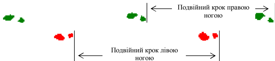
Рис. 3. Принцип визначення довжини подвійного кроку.
