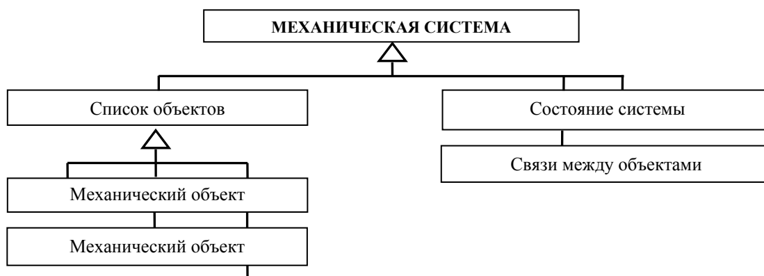
Рис. 3 Общія объектная модель механической системы
