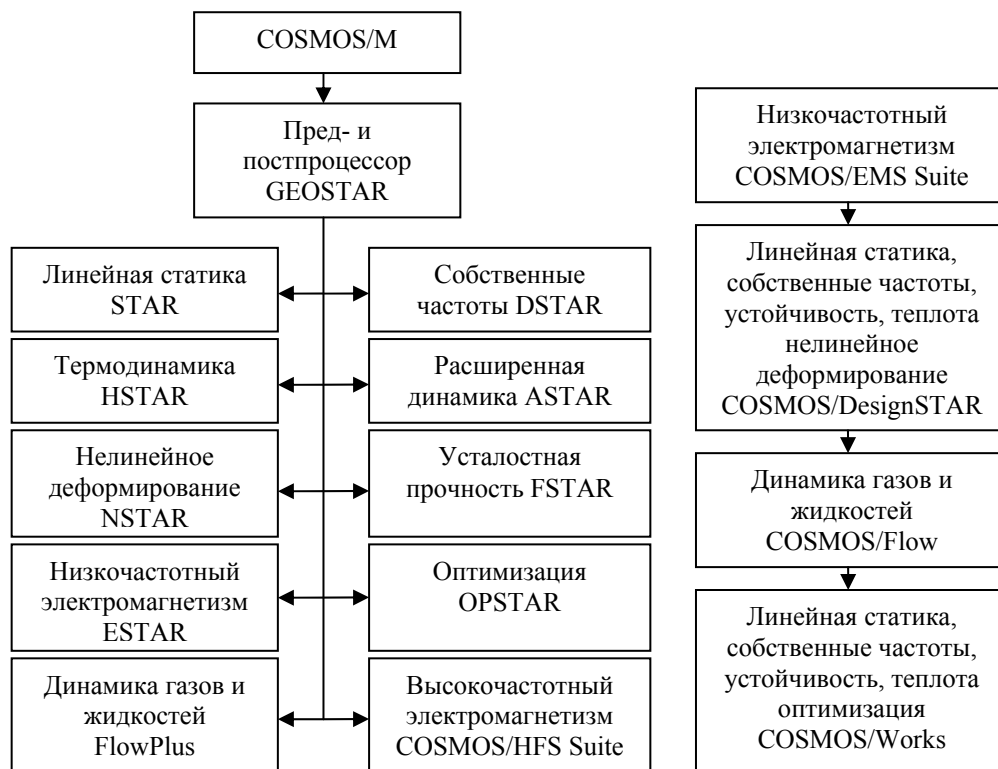
Рис. 1 Архитектура системы COSMOS/M
