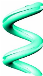
Рис.10. Фрагмент змеевика сложного поперечного сечения.
