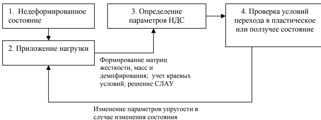
Рис. 6 б Модель состояний механического объекта
